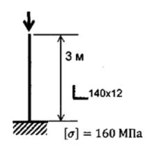
Определить критическую нагрузку для стойки
