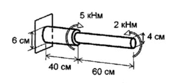
$[\tau] = 80 \ \text{M}\Pi \text{a} \quad [\phi] = 2^{\circ} \quad G = 8 \cdot 10^{4} \text{M}\Pi \text{a}$  Проверить прочность и жесткость вала
